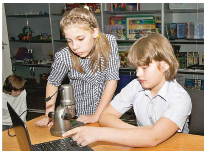
Цифровой микроскоп – это приспособленный для работы в школьных условиях оптический микроскоп, снабженный преобразователем визуальной информации в цифровую. Этот преобразователь обеспечивает возможность передачи в компьютер в реальном времени изображения микрообъекта и микропроцесса, его хранения, в том числе в форме цифровой видеозаписи, отображения на экране, распечатки, включения в презентацию.
