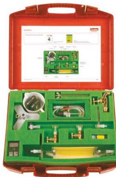
**В чемодане:** водонапорный бак, резервуар для воды, стояк с двумя кранами; центробежный насос с блоком питания (батарея 4,5 В); разборный штатив; аксессуары.
