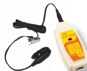
**Датчик частоты сердечных сокращений** контролирует интенсивность света, проходящего через сосуды ткани кончика пальца.
