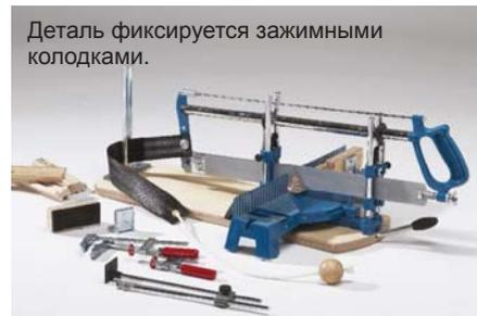
Деталь фиксируется зажимными колодками.
